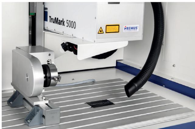
**Drehachse für Umfangsbeschriftung:**
