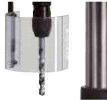
Protecteur de perçage à verrouillage électrique standard
