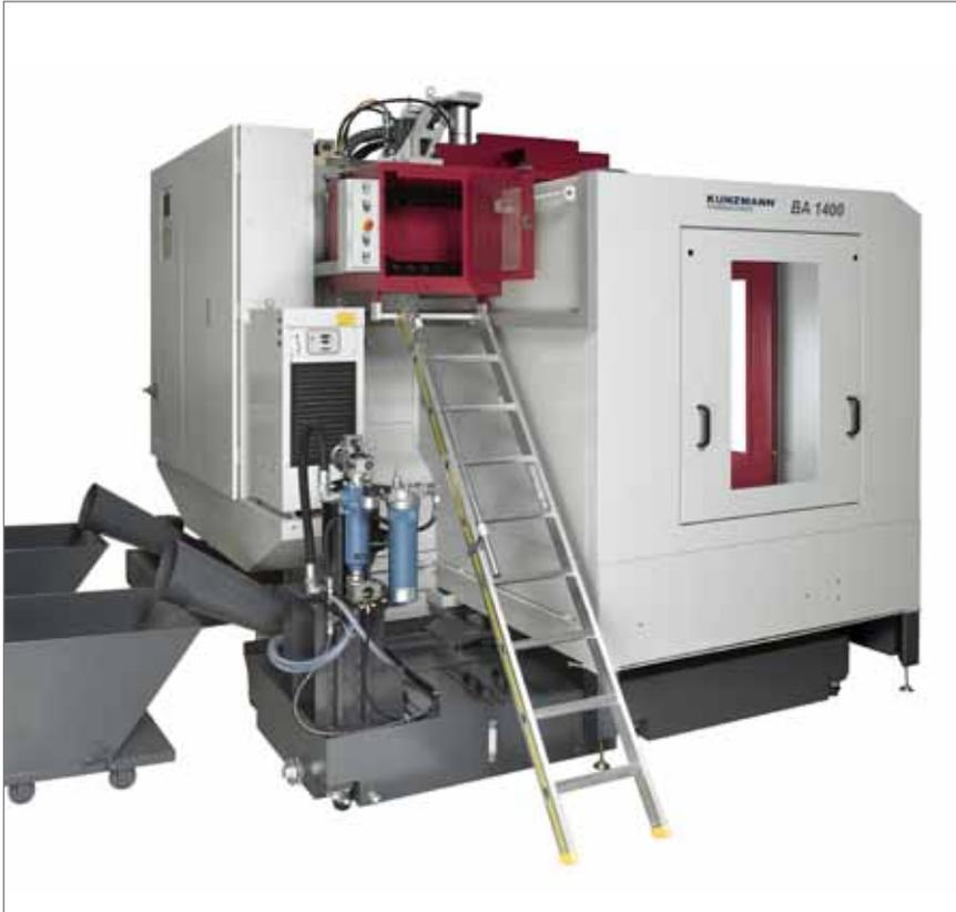
BA 1400 Späneauswurf und innere Kühlmittelzufuhr
