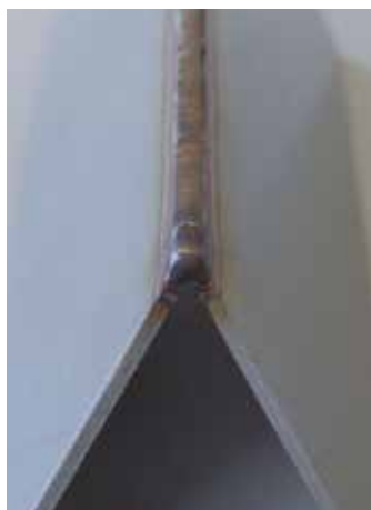
Hochfrequenzpulsen für perfekte Ecknähte
