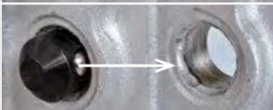
**Comparaison entre les broches de serrage à bille et les DEMMELE<sup>®</sup> broches de serrage polygonales**
