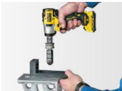
**Tournevis à accumulateur de la nouvelle génération avec système de changement rapide pour les broches de serrage rapide à segments PPS :** Un procédé d'accouplement mécanique astucieux pour un serrage et un desserrage sûrs et rapides des broches de serrage rapide à segments PPS brevetées à un couple élevé.
