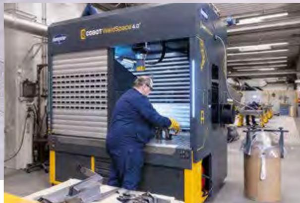
Le COBOT WeldSpace 4.0 offre la possibilité de souder simultanément plusieurs pièces, en partie différentes. Le déplacement automatique de l'enceinte permet de travailler en mode multi-postes. Pendant que le robot soude d'un côté, l'opérateur, protégé par des portes roulantes abaissables avec blindage en aluminium et verre de protection pour soudeurs intégré, peut équiper et effectuer les changements de serrage en temps réel de l'autre côté (fonctionnement à deux postes).
