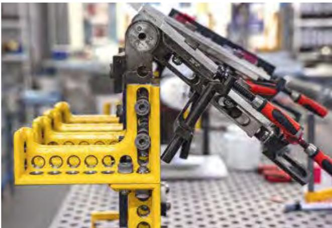
Grâce à la technologie de mesure 3D, il est également possible d'aligner spécifiquement les superstructures variables les unes par rapport aux autres. Il est donc possible de réaliser plusieurs configurations. Les composants de DEMMELE<sup>®</sup> sont utilisés à cette fin.
