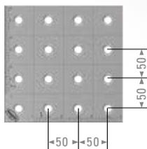
Plateau de table avec système d'alésage D16 dans la matrice de 50 x 50 mm
