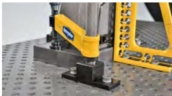
Utilisez les serre-joints et les prismes du système D28 également dans les systèmes D22 et D16
