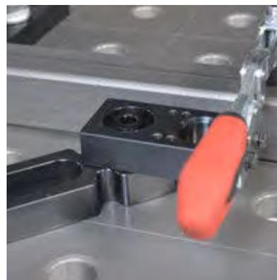
Les charges indiquées ne doivent pas être dépassées en cas d'utilisation de broches de serrage. L'apparition de tensions de soudage, de rapports de levier défavorables et de chocs doit être évitée.
