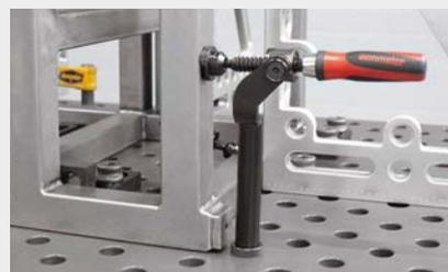
**Plage de réglage étendue.** Cette nouvelle conception permet de procéder au serrage simple des pièces à usiner rapprochées ainsi que des pièces à usiner plus éloignées du perçage suivant du système.
