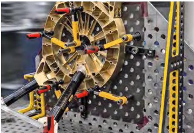
Le système de serrage de DEMMELER fait partie de cet ensemble complet. Les pièces composites sont collées à des composants métalliques avec une grande précision dans de nombreux projets. Pour cela, elles sont alignées et mesurées les unes par rapport aux autres ; c'est pourquoi la flexibilité et l'adaptabilité du DEMMELER système de serrage sont requises.
