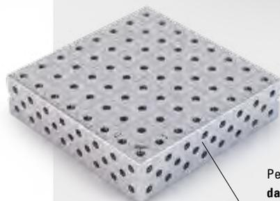
Perçage 3 rangées sur les flancs de table avec système d'alésage D16 dans la matrice 50 mm pour les rangées supérieure, inférieure et centrale
