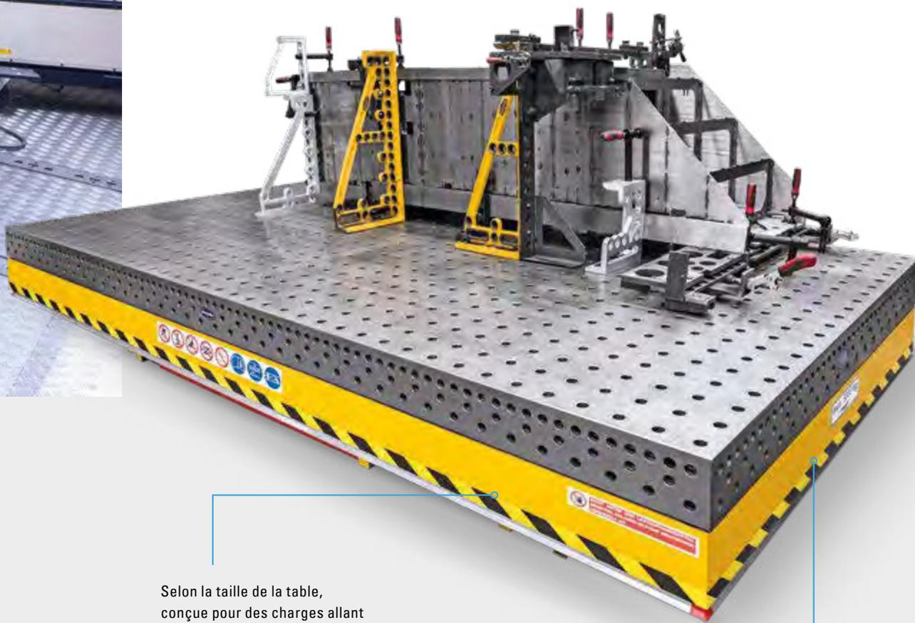
Selon la taille de la table, conçue pour des charges allant jusqu'à 1 à 6 tonnes maximum (après déduction du poids du plateau de table)
