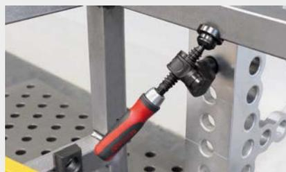
**Serrage précis.** Même lors d'un serrage en oblique des pièces à usiner, le serre-joint premium offre toujours un maintien solide. Pivotable en continu et à 360°, il s'adapte à toutes les situations de serrage.
