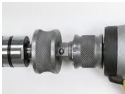
**Facilité d'utilisation et effort réduit :** Grâce au verrouillage de système DEMMELER entre les broches de serrage rapide à segments PPS et la visseuse à impulsions, l'insertion et le serrage ainsi que le desserrage et le retrait de la broche sont possibles d'une seule main.
