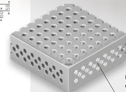
Perçage 3 rangées sur les flancs de table avec système d'alésage D22 dans la matrice diagonale 50 x 50 mm
