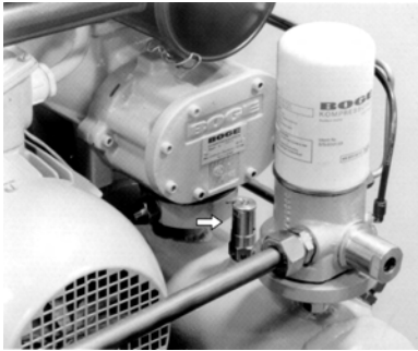
Bild 9.4 : Sicherheitsventil am kombinierten Druckluft- Öl-Behälters eines öleinspritzgekühlten Schraubenkompressors
