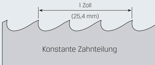
Die Zähne sind mit gleichem Abstand zueinander angeordnet. Die Zahl der Zähne pro Zoll (25,4 mm) bezeichnet die Verzahnung des Sägebandes.
