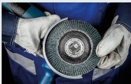
Setzen Sie das Werkzeug formschlüssig auf die X-LOCK-Aufnahme.
