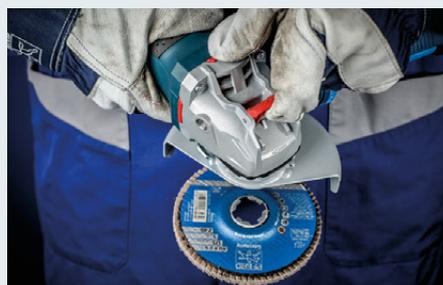
Lösen Sie das Werkzeug durch Betätigen des Hebels.
