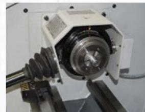
Hebelschnellspannfutter für Druckspannfutter
