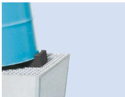
**La cale pour fûts PE** permet de placer des fûts en acier et en plastique de 200 litres dans un angle permettant une vidange optimale du fût à l'aide d'une pompe L x P x H (mm) : 217 x 214 x 97
