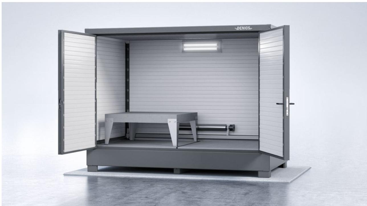
Vous pouvez stocker jusqu'à 8 fûts de 200 litres sur des palettes Europe/Chimie ou directement sur des caillebotis dans la construction en acier robuste et protégée contre la corrosion avec bac de rétention intégré. Le conteneur de stockage peut également accueillir jusqu'à deux cuves IBC. En outre, grâce aux passages pour fourches, il peut être facilement déplacé et levé avec un chariot élévateur ou un transpalette haute levée.
