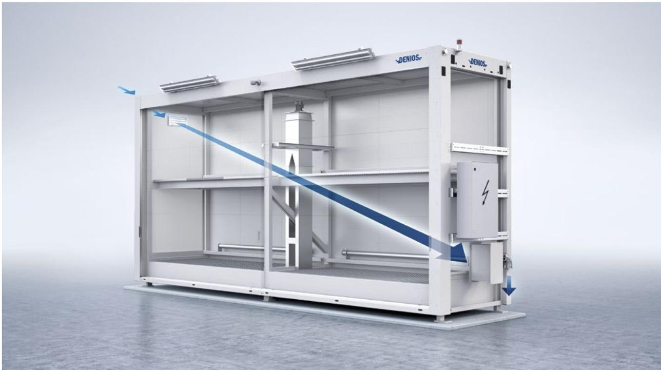
Si des substances susceptibles de présenter un risque d'accumulation d'atmosphère explosive sont stockées dans le conteneur de stockage multi-niveaux SC pour substances dangereuses, une ventilation suffisante doit être prévue. Une ventilation technique très performante assure une aération transversale permanente.
