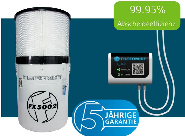
Gelochte Filtertrommel dreht mit hoher Geschwindigkeit, saugt den Ölnebel in die Trommel und die Zentrifugalkräfte drücken das Öl an die Außenwand des Gerätes, wo es zur Wiederverwendung oder Sammlung zurück zur Maschine abfließt. Saubere Luft strömt oben aus dem Gerät in die Werksräume.
