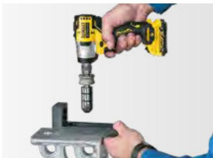
**Power-Schrauber der neuesten Generation mit Schnellwechselkupplung für den PPS-Bolzen:** Cleverer Formschluss beim sicheren und schnellen Spannen und Lösen der patentierten PPS-Bolzen mit hohem Drehmoment.
