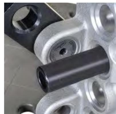
Die angegebenen Belastungen dürfen bei der Anwendung der Spannbolzen nicht überschritten werden. Das Einleiten von Schweißspannungen, ungünstige Hebelverhältnisse und Schläge müssen beachtet bzw. vermieden werden.
