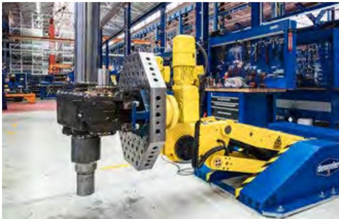
Durch den großen Arbeitsraum bei gleichzeitig kleiner Stellfläche ist der DEMMELER Manipulator Ergonomix®M die ideale Ergänzung der fortschrittlichen Produktionsstätte. Dank des patentierten Schwenkbereichs von bis zu 180° lassen sich die Werkstücke in einer Aufspannung ohne zusätzliches Umdrehen fertigbearbeiten.
