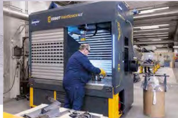
Mit der COBOT WeldSpace 4.0 können mehrere, teilweise unterschiedliche Teile gleichzeitig geschweißt werden. Das automatische Verfahren der Umhausung ermöglicht das Arbeiten im Mehrstationenbetrieb. Während der Roboter auf der einen Seite schweißt, kann der Bediener geschützt durch herunterfahrbare Rolltore mit Aluminiumpanzer und integriertem Schweißerschutzglas auf der anderen Seite zeitparallel Rüsten und Umspinnen (Zwei-Stationen-Betrieb).
