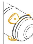
Gleichmäßige Kraftverteilung der Polygone verringert den Verschleiß der Bohrungen im Vergleich zu herkömmlichen Bolzen. Das Kegelanpresssystem erreicht eine 100-mal größere Auflagefläche.
