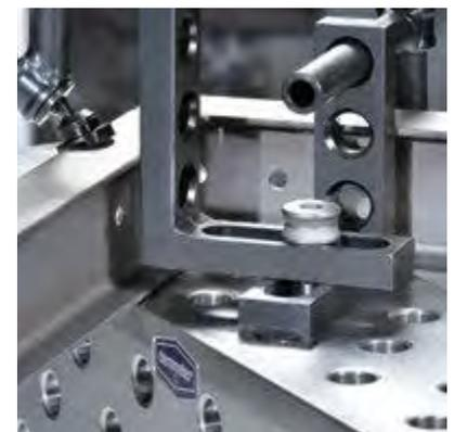
Die angegebenen Belastungen dürfen bei der Anwendung der Spannbolzen nicht überschritten werden. Das Einleiten von Schweißspannungen, ungünstige Hebelverhältnisse und Schläge müssen beachtet bzw. vermieden werden.
