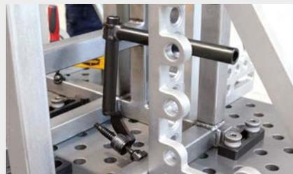
**Enge Platzverhältnisse.** Die DEMMELER Performanceschraubzwinde ermöglicht einfaches Spannen auch an schwer zugänglichen Stellen. Dabei sorgt der Druckteller mit Prisma für eine zentrische Kräfteverteilung.
