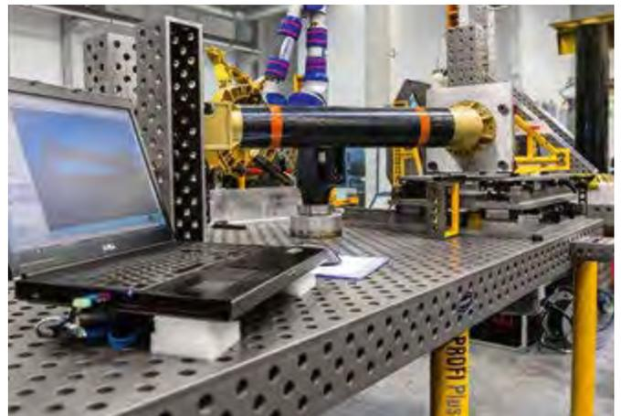
Durch die zur Verfügung gestellte CAD-Datenbank aller Module können diese Aufbauten im Detail geplant und somit Zeit und Geld gespart werden. Selbst komplexe Kundendesigns werden mittels individuell designter Adapter mit dem DEMMELER System präzise verbunden.
