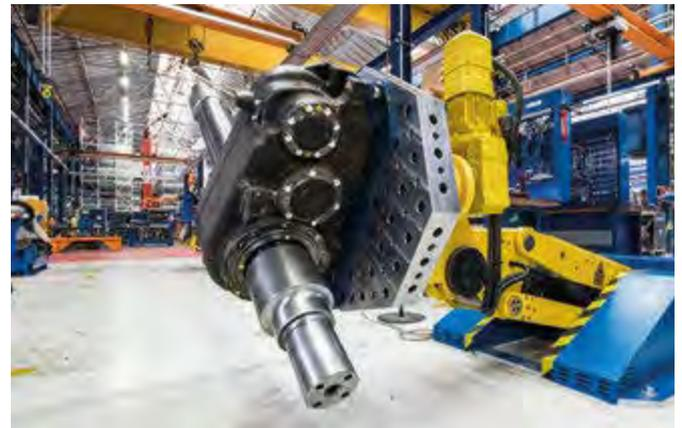
Dabei bringt der Manipulator, der sich in Höhe und Winkel flexibel verstellen lässt, höchste Zuladungen immer in die Idealposition und ermöglicht somit eine ergonomische Arbeitshaltung auch bei schweren Handlingaufgaben. Die Montagearbeiten werden somit ermüdungsfrei und mit gleichbleibend hoher Präzision ausgeführt.
