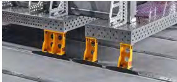
Verschieben von aufgebauten Systemteilen ohne Einsatz von Hebezug und Kran möglich.
